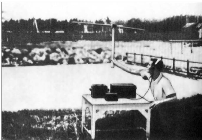
*Рис. 1. Приемная часть радиолокатора непрерывного излучения при испытаниях под Ленинградом в июле 1934 г.*
